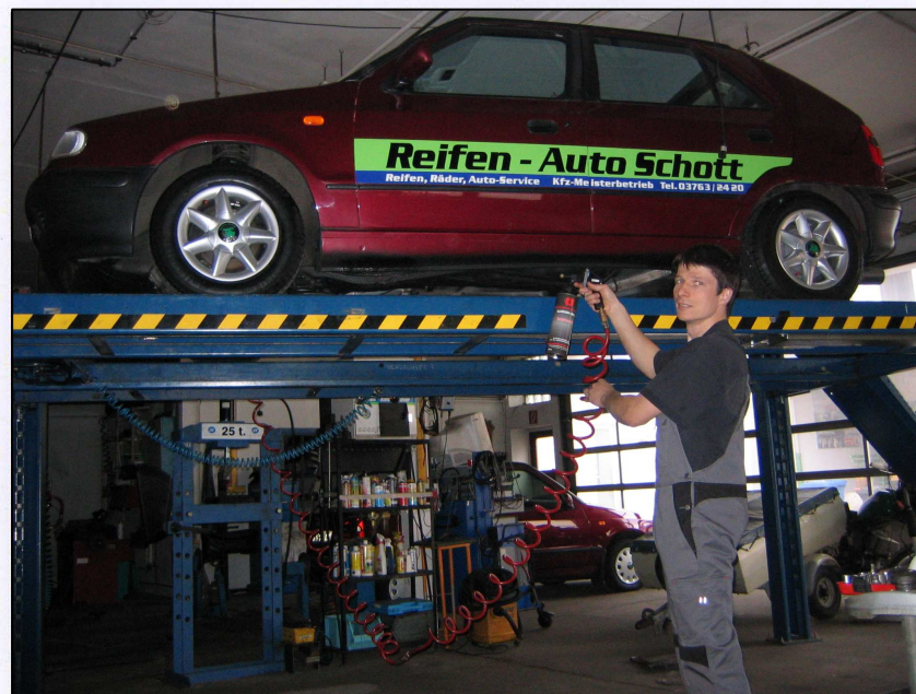
■ Kfz-Meister Stefan Schott bei der Unterbodenkonservierung seines Fahrzeuges mit Elaskon-Pflegeprodukten.
